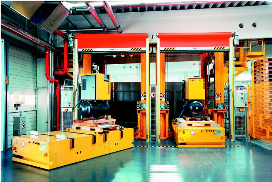
AGV 3 kW SuperCap chargers in Coburg (Kaeser)
