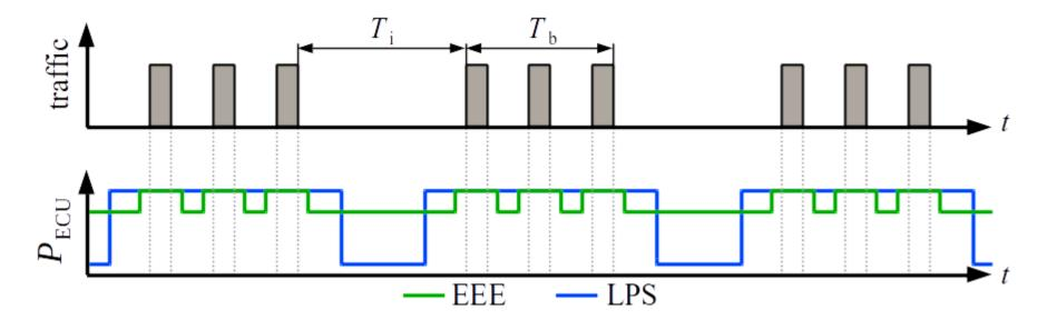
$$P_{\text{ECU}} = \frac{P_{\text{i}}T_{\text{i}} + P_{\text{b}}T_{\text{b}}}{T_{\text{i}} + T_{\text{b}}}$$
